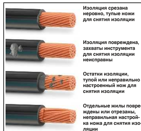
Ошибки снятия изоляции по DIN МЭК 60352
