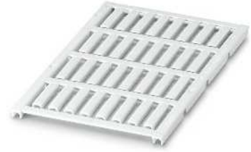
32 шильдина для проводов диаметром от 2,9 до 3,6 мм, поле для нанесения надписи 21 x 4,5 мм
