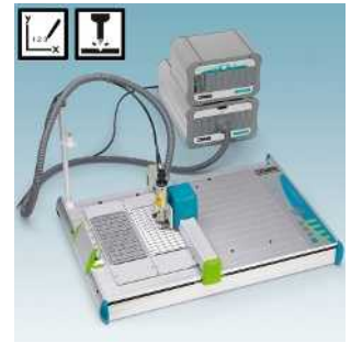
Плоттер с гравировальным узлом P1 ENGRAVING UNIT Стр. 45
